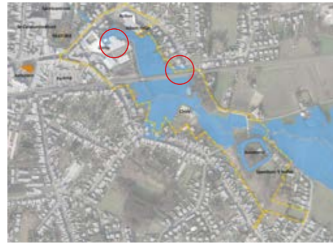
Fluviale overstrooming T100 huidig klimaat
