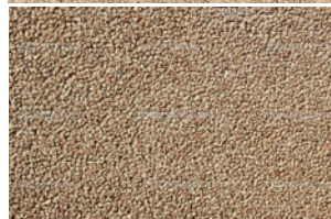
Halfverharding - dolomiet - gemalen steenslag
